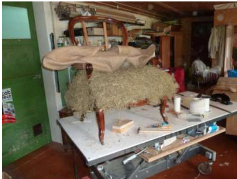
La garniture en crin végétal. Ci dessus, les différents points de piquage (point de fond, point droit et point de bourrelet) pour une bonne tenue dans le temps de la garniture.
