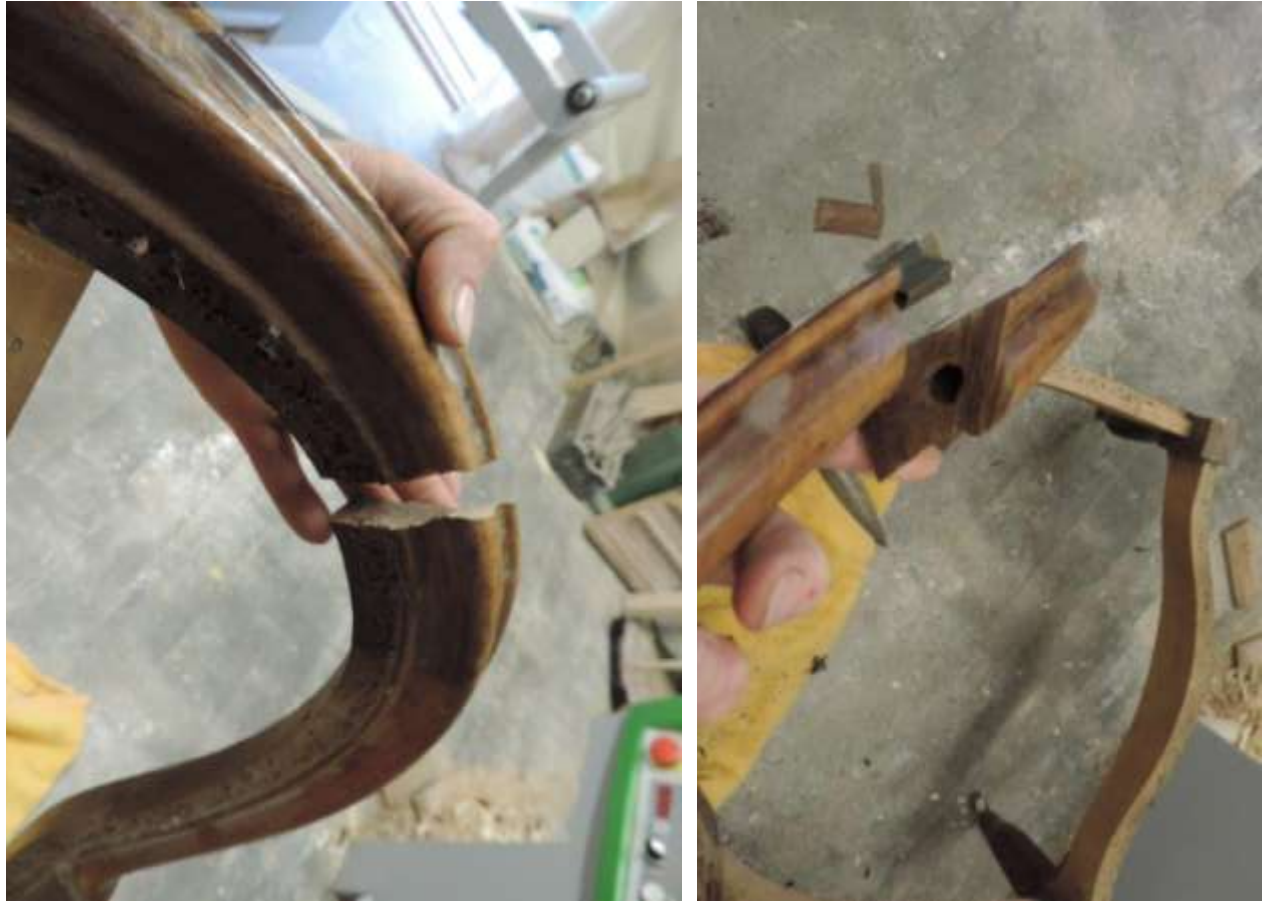
La cassure du dossier est réparée par la mise en place d'un tourillon..
