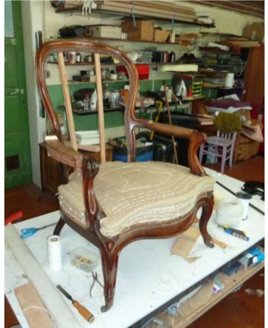
La garniture en crin végétal. Ci dessus, les différents points de piquage (point de fond, point droit et point de bourrelet) pour une bonne tenue dans le temps de la garniture.
