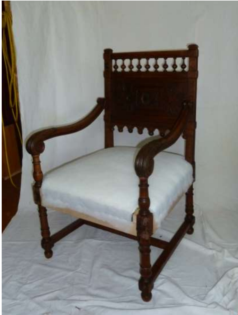
Une ouate polyester et une toile blanche termine la garniture avant la pose du tissu et des clous de finition.
