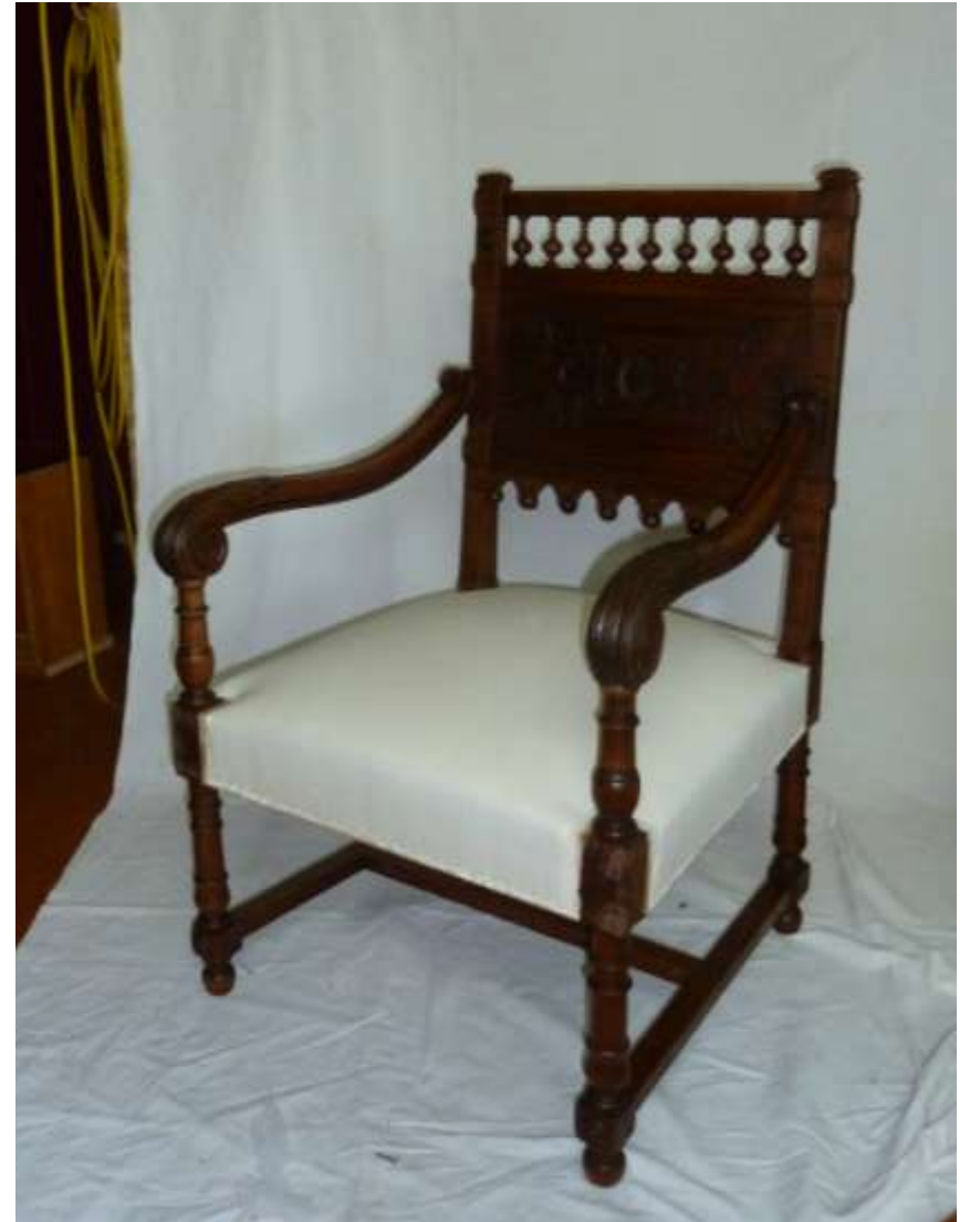
Une ouate polyester et une toile blanche termine la garniture avant la pose du tissu et des clous de finition.
