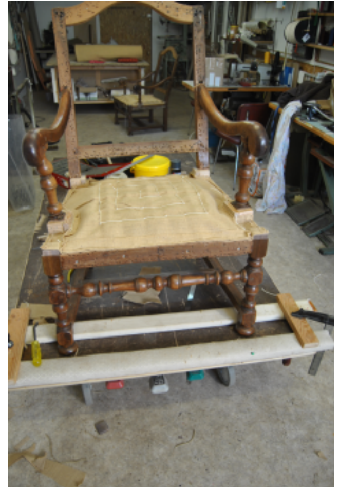
Sur les ressorts, une toile de jute forte, c'est elle qui recevra le crin végétal des garnitures.
